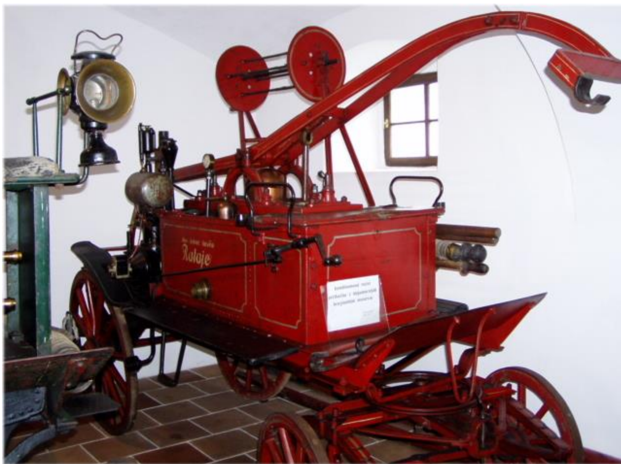
Kombinovaná ruční stříkačka s výpomocným benzínovým motorem z roku 1886. V hasičském muzeu v Bechyni je uložena od roku 1975.
